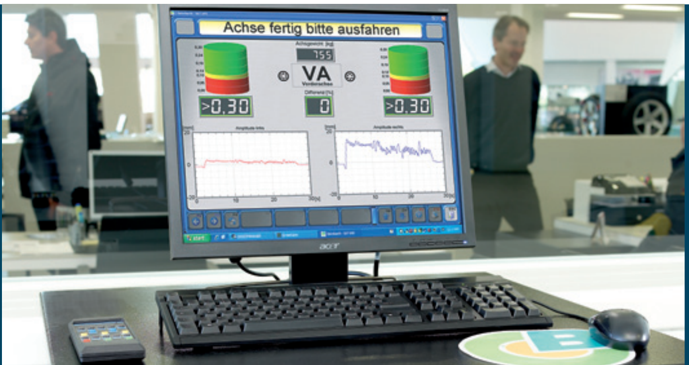
Saubere, klare Darstellung der ermittelten Werte mit Amplitude für beide Dämpfer.
