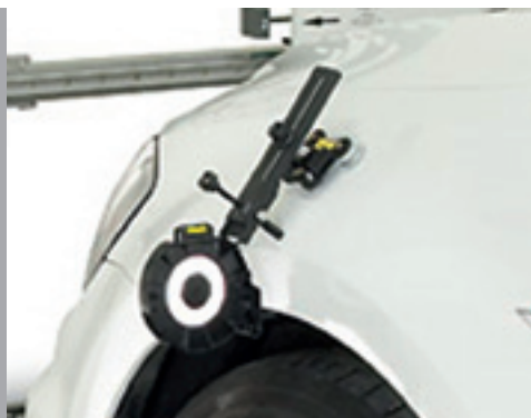
Optional: Höhenstandsmessung bei der Eingangsmessung mit automatischer Sollwertanpassung.
