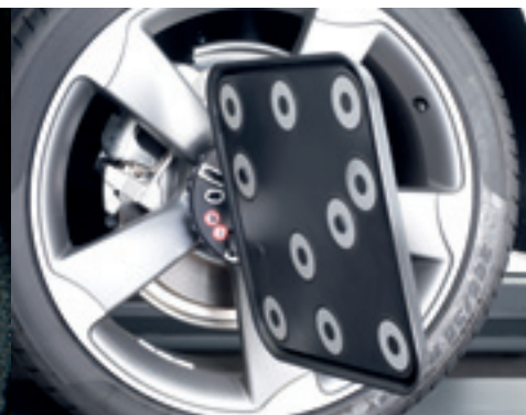
Die Messtafeln sind per Magnethalter schnell angebracht.
