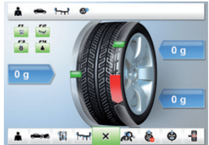
Erleichtert die Arbeit: Anzeige der Gewichtsplatzierung (verstecktes Kleben) hinter den Speichen.
