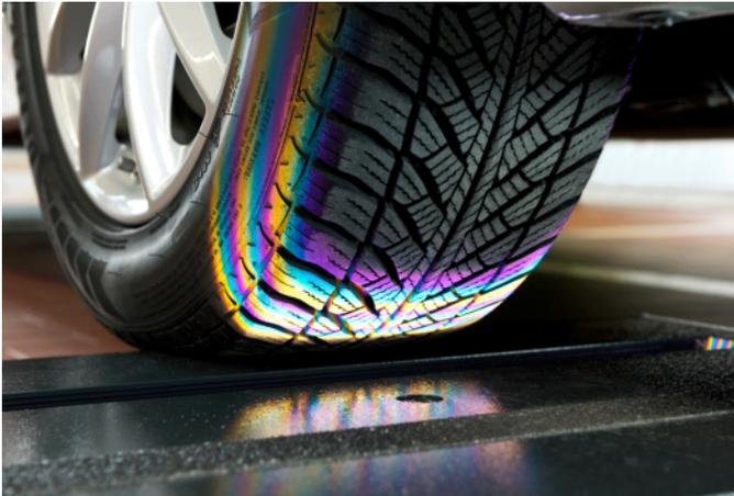
Hohe Drehmomente und schwere Batterien sorgen gerade bei Elektrofahrzeugen für extremen Reifenabrieb. Neben der Profiltiefe bewerten wir auch ungleichmäßige Abriebbilder im Überfahren und können so in wenigen Sekunden auch potenzielle Fahrwerksprobleme und Luftdruckprobleme erkennen.
