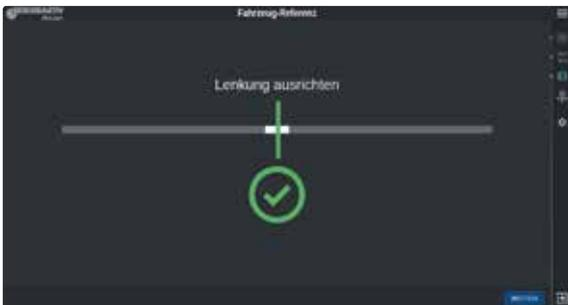
Überprüfung der Lenkradstellung vor der Kalibrierung
