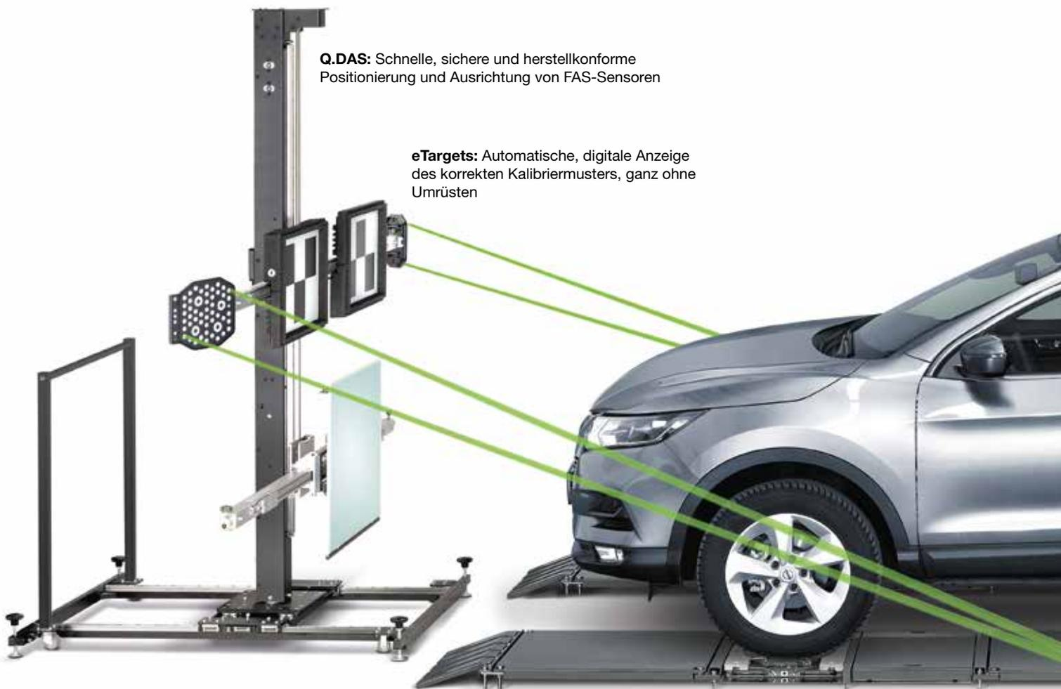
**Q.DAS:** Schnelle, sichere und herstellerekonforme Positionierung und Ausrichtung von FAS-Sensoren
