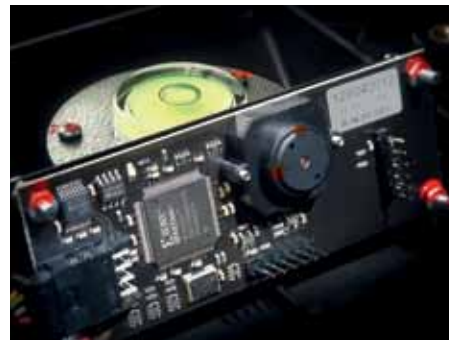
CMOS-Kamera mit hoher Auflösung und Bildrate
