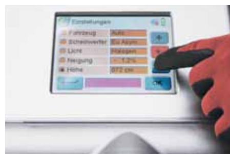
Bedienpanel um 180° verstellbar (Bedienung auch mit Handschuh)
